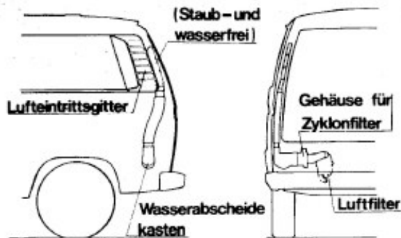
Bild 9. Verbrennungsluftansaugung aus dem linken oberen Eckteil; zusätzlicher Zyklonabscheider für staubreiche Länder
