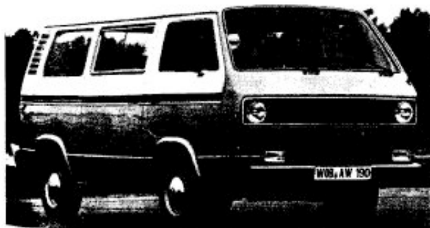
Bild 1. VW-Transporter mit 1,6-l-Vierzylinder-Dieselmotor; für den Kühler in Front wurde ein zweiter Grill erforderlich
